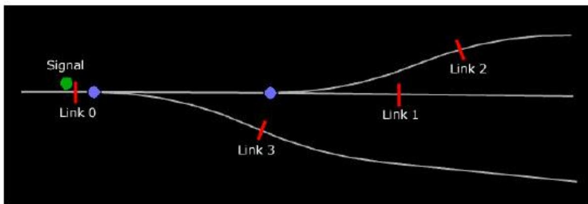
**IMPORTANT:** *il est absolument inutile de positionner les liens autres que le lien 0 au niveau du signal suivant (sauf cas particulier). Cet espace est de toute façon pris en compte par le script du signal pour assurer l'espacement des trains. La pose n'en sera ainsi que plus simple et plus claire.*
