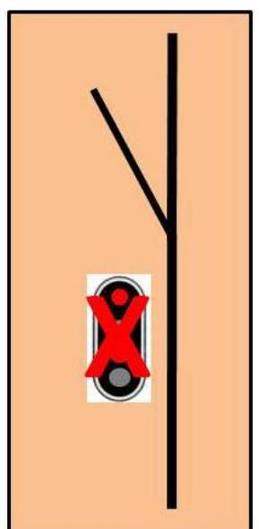
Voici en block automatique lumineux le déroulement d'une séquence avec les signaux à distance d'arrêt du signal suivant sur une voie à vitesse maximale d'exploitation inférieure ou égale à 160 km/h:
