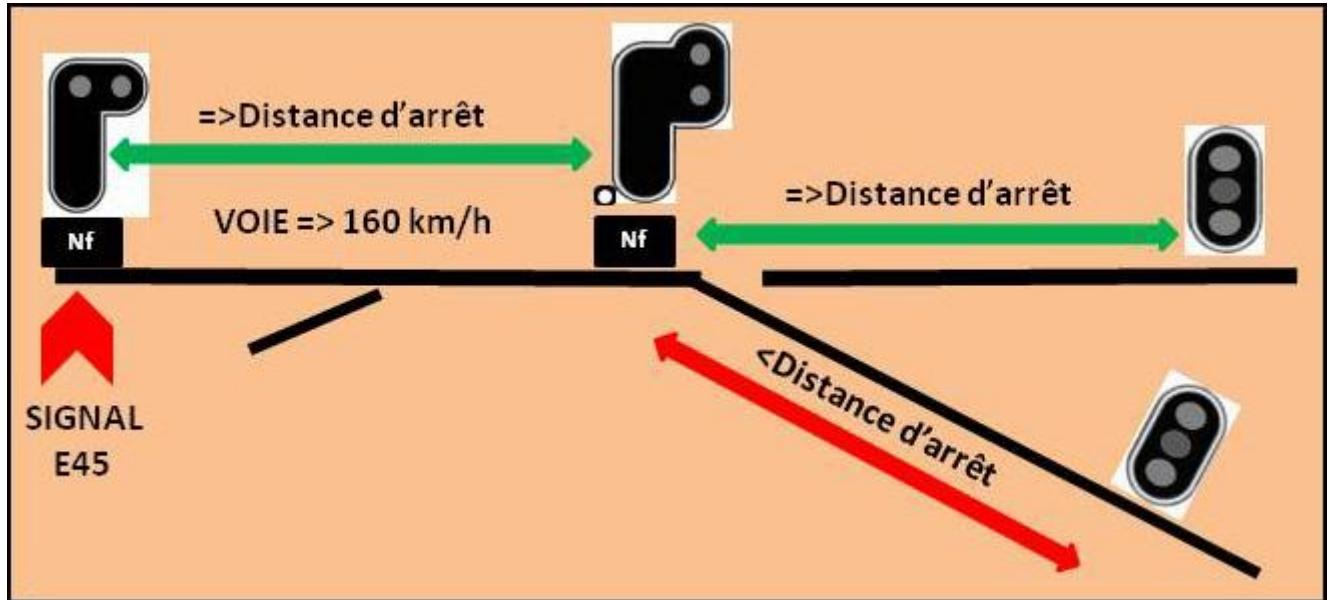
Le signal E47 est utilisé sur les voies à vitesse maximale d'exploitation supérieure à 160 km/h lorsque tant sur la voie directe que sur la voie déviée les signaux ne sont pas à distance d'arrêt du rappel.
