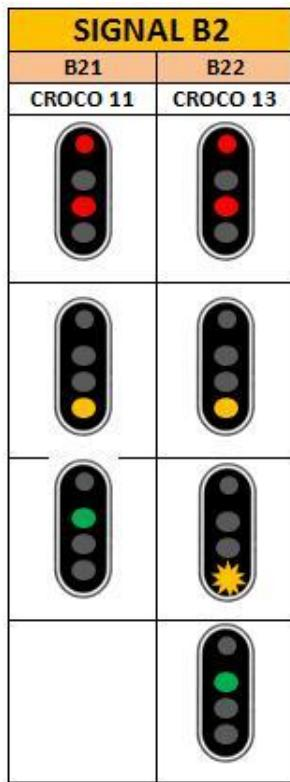
Le signal B2 est utilisé pour pouvoir effectuer des manœuvres de rebroussement. Avec un signal normal, lorsque l'on rebrousse sur une autre voie et que l'aiguillage se remet en position initiale, notre signal de départ reste au rouge. Il faut donc un signal spécialement conçu à cet effet.
