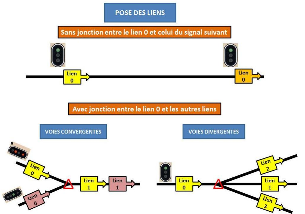
Le lien 0 doit être placé légèrement en arrière du signal pour que le conducteur ne voit pas le signal passer au rouge en le franchissant.
