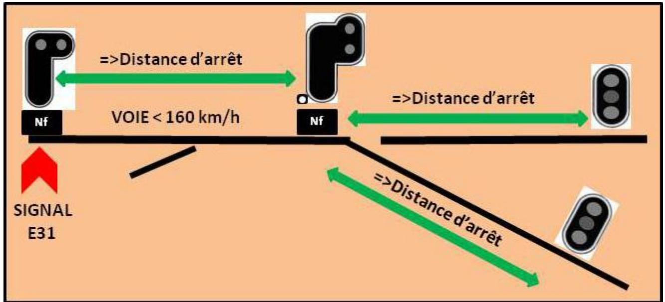
Le signal E33 est utilisé sur les voies à vitesse maximale d'exploitation inférieure ou égale à 160 km/h lorsque les deux cas suivants sont remplis :
