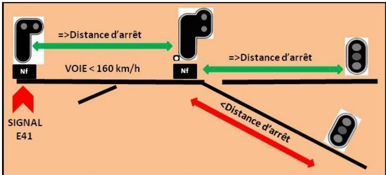
Le signal E43 est utilisé sur les voies à vitesse maximale d'exploitation inférieure ou égale à 160 km/h lorsque tant sur la voie directe que sur la voie déviée les signaux ne sont pas à distance d'arrêt du rappel.
