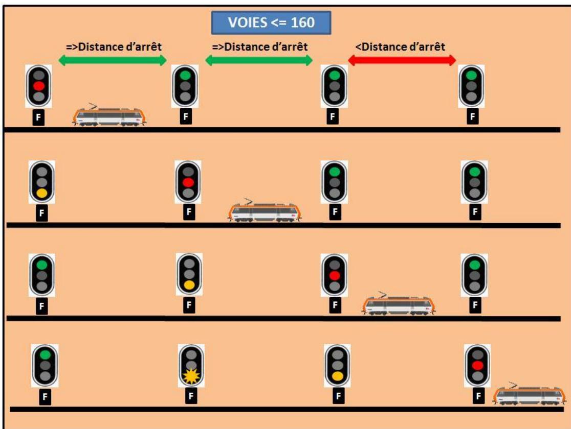
Voici maintenant en block automatique lumineux le déroulement d'une séquence avec les signaux à distance d'arrêt du signal suivant sur une voie à vitesse maximale d'exploitation supérieure à 160 km/h:
