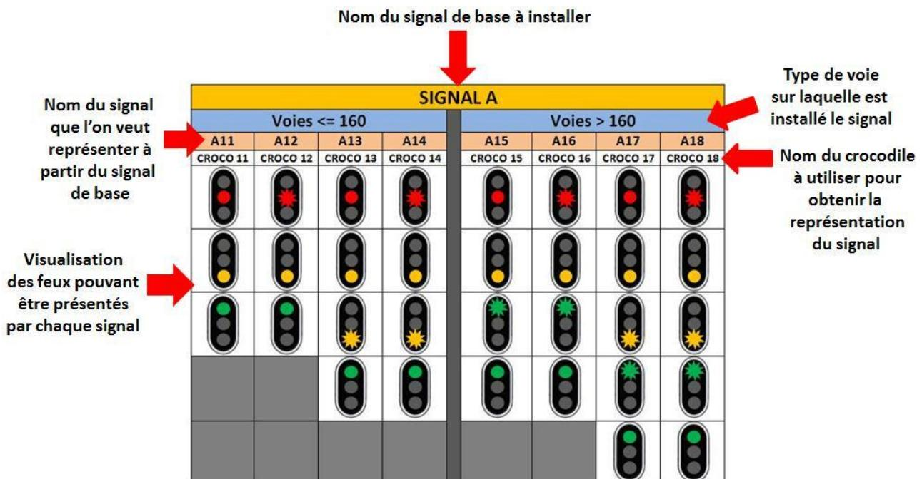
**Attention : il ne doit pas y avoir d'éléments de signalisation (comme des pédales de commande) entre le crocodile et le signal**
